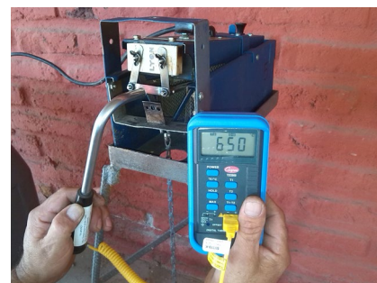
使用超高温温度计来测量刀片温度，需达到650°C左右
